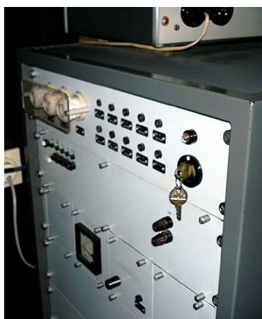
Фигура 2.3. Захранващ шкаф (вляво) и амперметър за тока на ЛКК (вдясно). Върху шкафа е поставен стабилизаторът за лампата за плоско поле.
